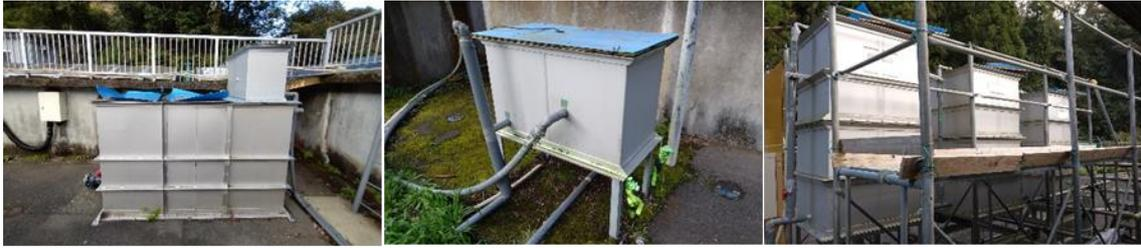
写真 - 1 実験装置外観（左から原水計量槽・沈砂槽、沈砂水計量槽、粗ろ過槽）
