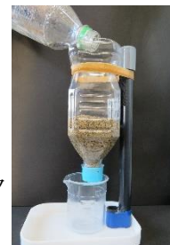
⑧ ろ過装置完成
